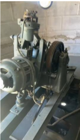
Figura 5 – Motor de tração
